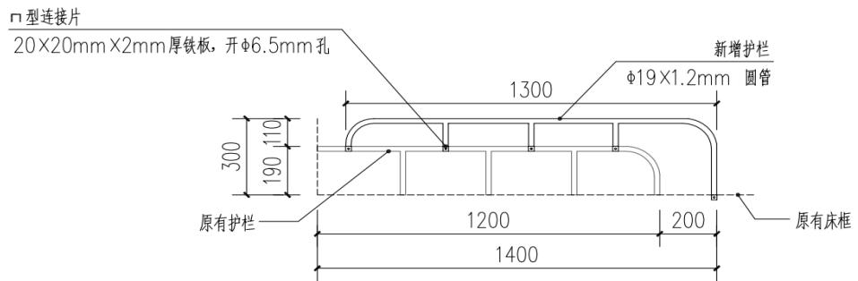
钢管框架床围 C 型:
